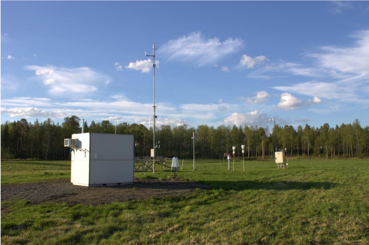
Figur 6: NILUs målestasjon på Svanvik. Den ligger ute på jordet ved Bioforsk Jord og miljø/Svanhovd miljøsenters. I 2012 ble det installert ny målebod. Merk inntak for støvmålinger på taket til venstre og inntak for SO 2 -målinger på taket til høyre (svanehal). Masten har meteorologiinstrumenter både i 2 og 10 m høyde. To nedbørprøvetakere til høyre tar prøver for tungmetaller. Instrumentet helt til høyre tilhører NVE. Stativet med metallplater i bakgrunnen er en del av et europeisk korrosjonsprosjekt (Grøntoft og Ferm, 2014). Strålevernets instrumenter er skjult bak måleboden.
