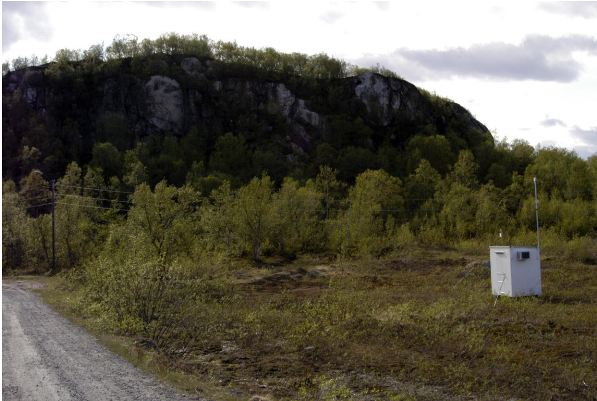
Figur 8: Målestasjonen i Karpdalen sett fra sør-øst. Stasjonen er plassert ute på et myrete jorde, samme sted som i 1986-94. Like vest for stasjonen er det en liten kolle. Trakt og svanehal på taket til venstre er inntak for SO 2 , mast til høyre er meteorologiinstrumenter. Legg også merke til barduneringen, det er værhardt i Karpdalen om vinteren. Bildet er tatt i 2009, dvs. før utplassering av prøvetakere for tungmetaller. Merk også nærhet til vei og strøm, infrastruktur er viktig kriterium for valg av plassering av målestasjon.
